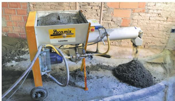
Un flussimetro controlla in automatico (dopo aver per prima cosa verificato la consistenza dell'impasto) il dosaggio dell'acqua senza bisogno di regolazioni manuali riducendo al minimo gli errori. Tenendo alimentata la tramoggia il premiscelato viene impastato e distribuito in continuo direttamente a terra con produttività orarie sino a 1,8 m<sup>3</sup>/ora.
