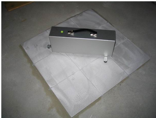
Foto 5: misurazione livello di rumore di calpestio con ceramica
