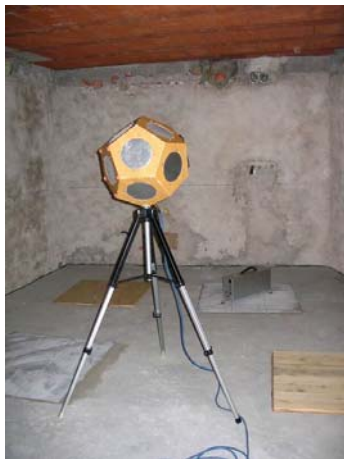
Foto 3: misurazione potere fonoisolante, camera sorgente al primo piano
