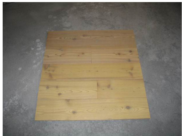
Foto 6: misurazione livello di rumore di calpestio con parquet incollato
