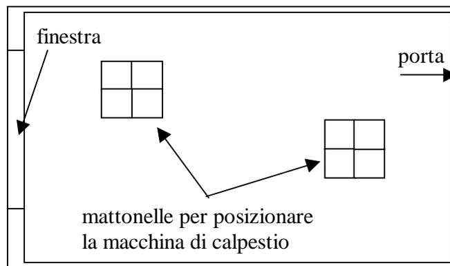
Figura 1: schema in pianta degli ambienti di misura con indicazione dei gruppi di 4 mattonelle di ceramica utilizzati per il posizionamento della macchina di calpestio
