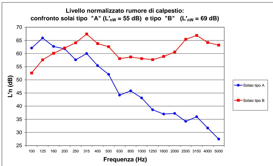
Figura 4: grafico di confronto del livello normalizzato di rumore di calpestio  $L'n$  dei due solai divisori testati: tipo "A" galleggiante con "Calpestop super 5" e Lecamix 10 cm e tipo "B" tradizionale, con massetto sabbia-cemento spessore 10 cm
