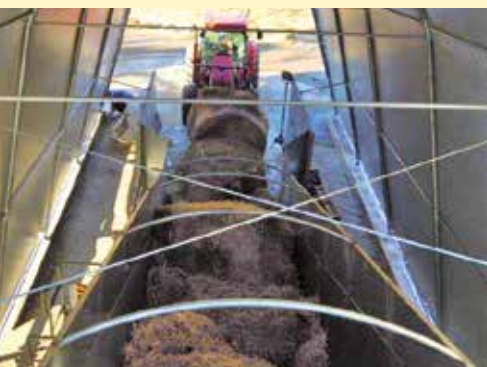
L'impianto a biomasse di Enna: caricamento rotoballe di fieno.
