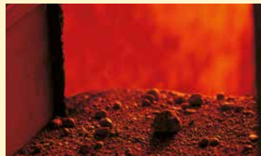
Cottura a 1200°C ed espansione.
