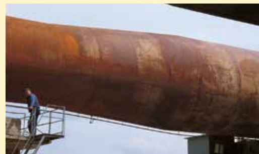
Forno rotante di produzione.
