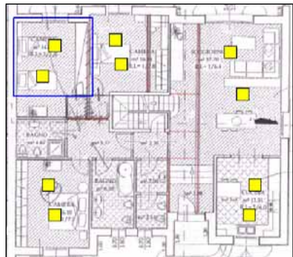
Figura 1: schema in pianta dell'ambiente sorgente con indicazione dei gruppi di mattonelle di ceramica utilizzati per il posizionamento della macchina di calpestio. Figura 2: schema in pianta dell'ambiente ricevente (camera).
