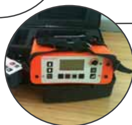
Pacometro , strumento in grado di localizzare le barre di armatura presenti nel getto di calcestruzzo.
