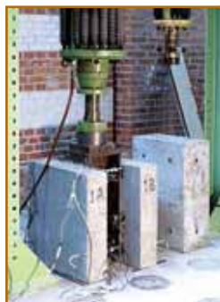
Resistenza a trazione Connettore. Disposizione degli strumenti di misura sul campione.
