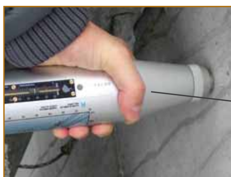
Sclerometro , strumento utile alla valutazione della resistenza locale del calcestruzzo.
