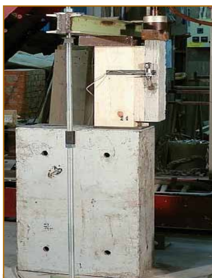
Disposizione degli strumenti di misura sul campione.
