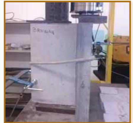
Disposizione degli strumenti di misura sul campione.
