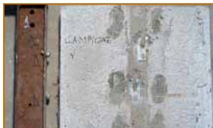
Resistenza a trazione Connettore. Aspetto del campione al termine della prova.
