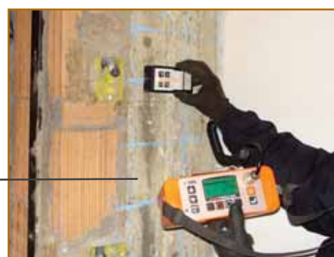
Pacometro , strumento in grado di localizzare le barre di armatura presenti nel getto di calcestruzzo.
