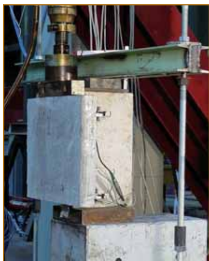
Disposizione degli strumenti di misura sul campione.
