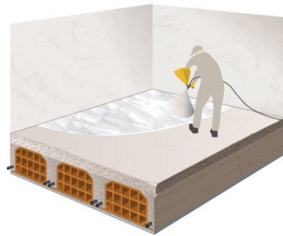
Figura.9 - Posa in opera Connettore Chimico, sul solaio/solaio armato
