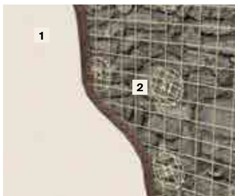
Intonaco armato leggero.
