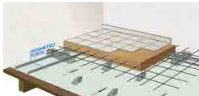
Consolidamento antisismico con cerchiatura perimetrale (Perimetro Forte) e rinforzo statico.
